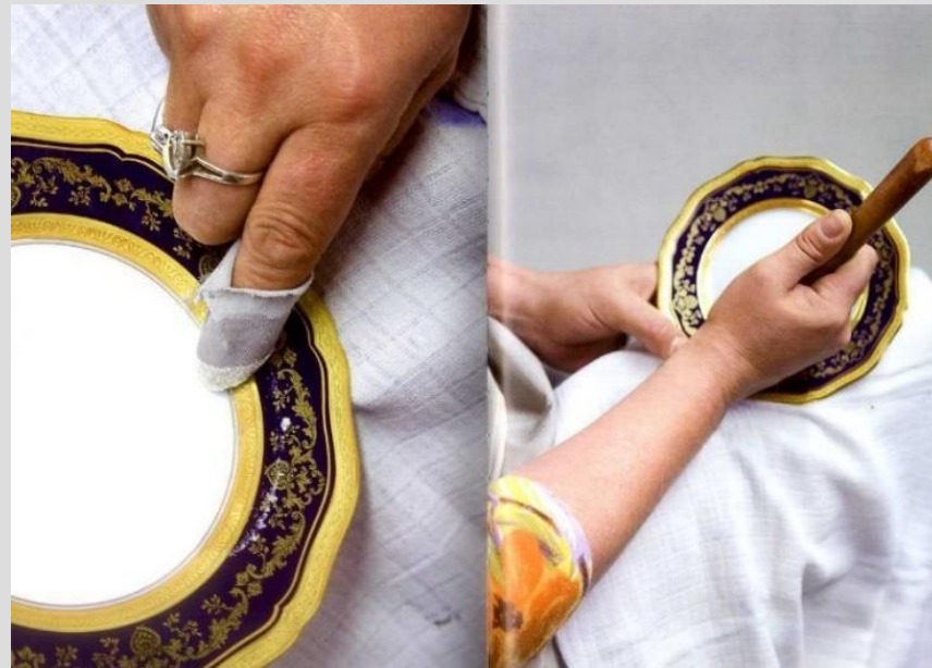
Técnica de incrustación : pulido con ágata
